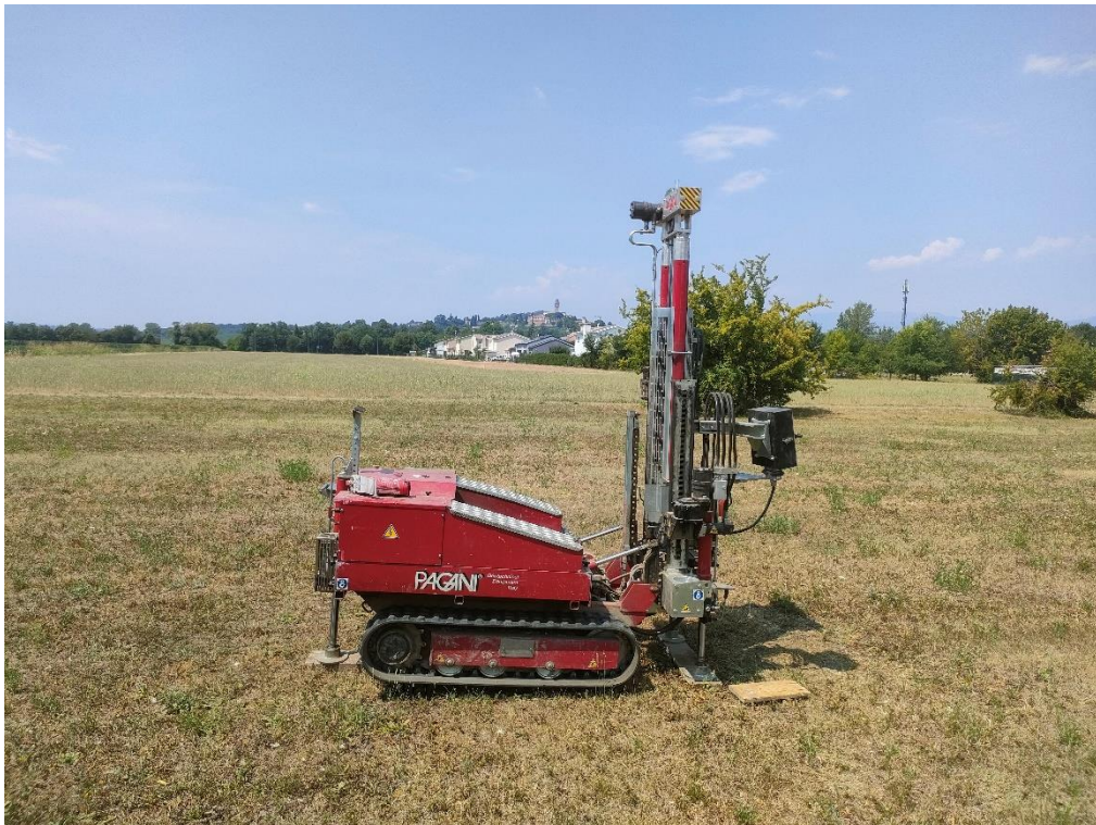
Foto n.5 – Esecuzione prova penetrometrica dinamica superpesante (DPSH5)
