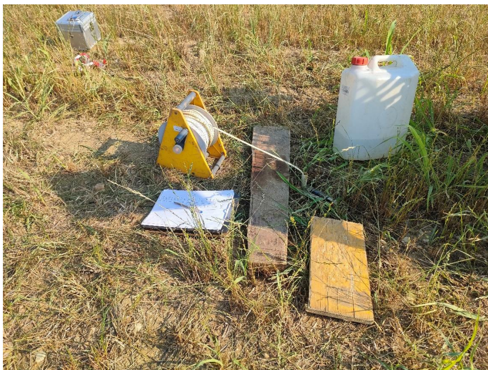
Foto n.7 – Esecuzione prova di permeabilità in foro di sondaggio (K1)
